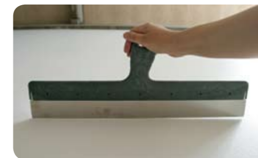
Iboende planhedsafvigelser kan afsløres med eksempelvis en spartel.
